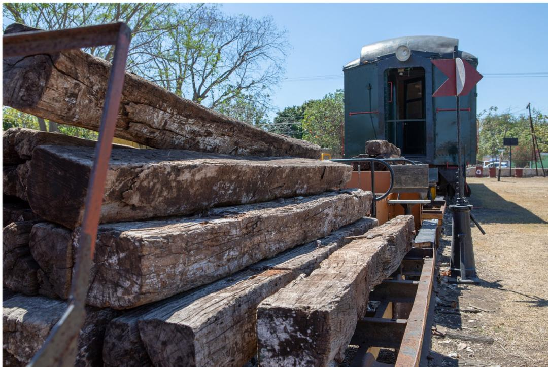
Plana, que transportaba maderos para mantenimiento de vías
